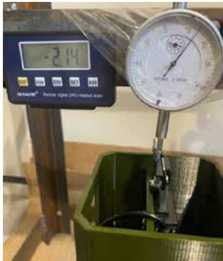
Рис. 6. Результати випробування переміщення на приладах PP-01 та індикаторі стрілкового типу ІЧ 0,01
