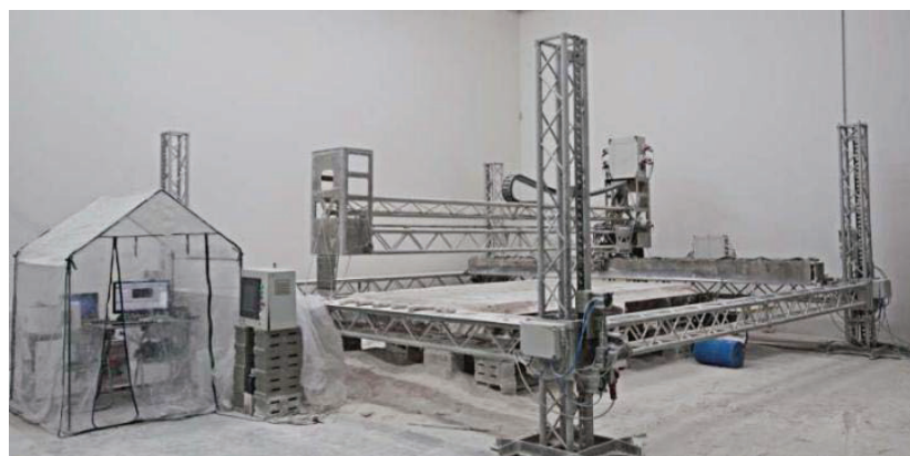
Рис. 4. Будівельний 3D-принтер за технологією “D-Shape” [22]
