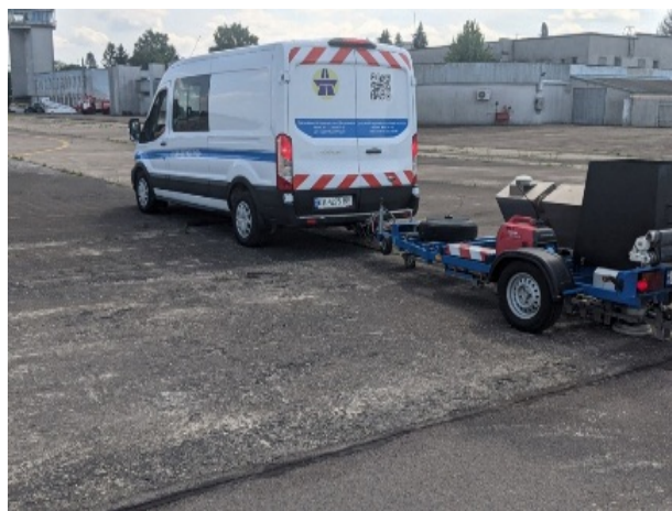
Рис. 6. Процес визначення модулів пружності установкою динамічного навантаження Dynatest FastFWD
