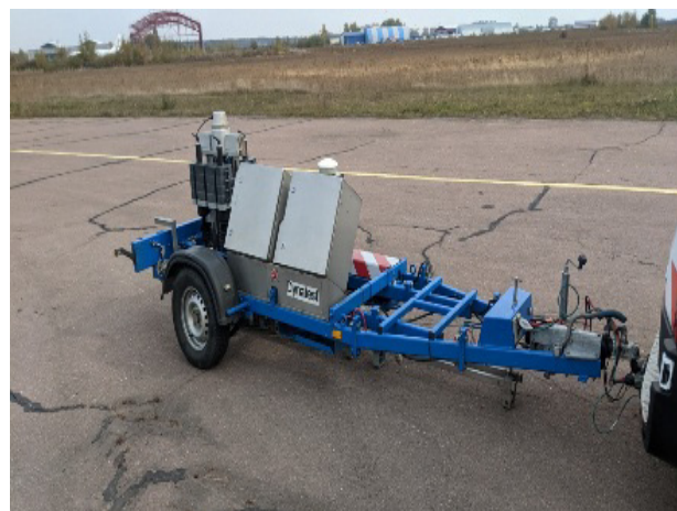
Рис. 6. Процес визначення модулів пружності установкою динамічного навантаження Dynatest FastFWD
