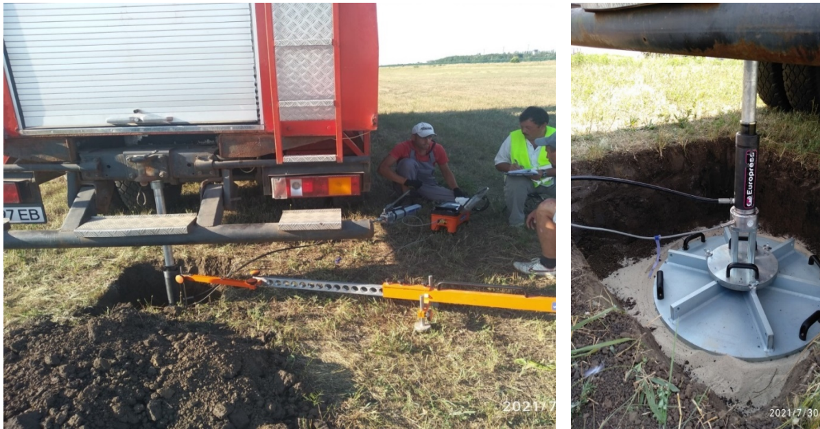
Рис. 3. Фотоілюстрація проведення штапових випробувань із визначення коефіцієнта постелі ґрунтової основи
