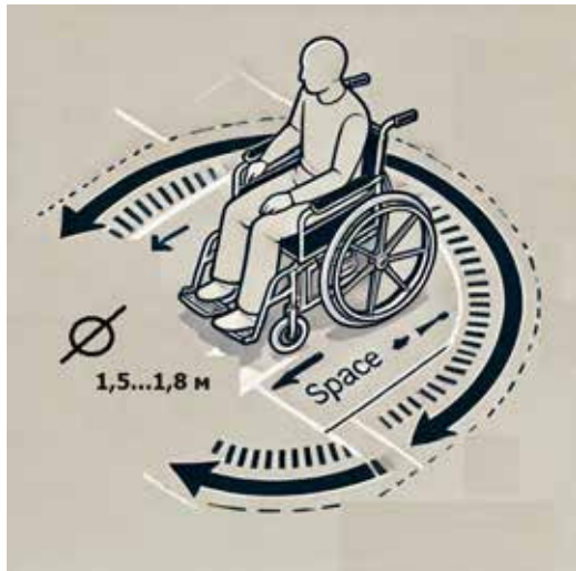
Рис. 4. Простір, потрібний для маневрування інвалідного візка
