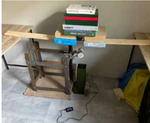
Рис. 4. Випробування переміщення на пристосування PP-01 (електронна меса SHANE 5403-200F)
